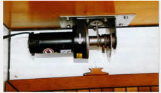
Etwas Technik: Das Schwertfall wird mit einer Elektrowinde bedient, die abdeckbar im am Niedergang montiert ist.
